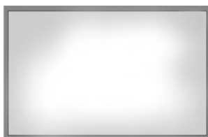
Bez DUE: widoczne nierównomierności w odcieniu i jasności
